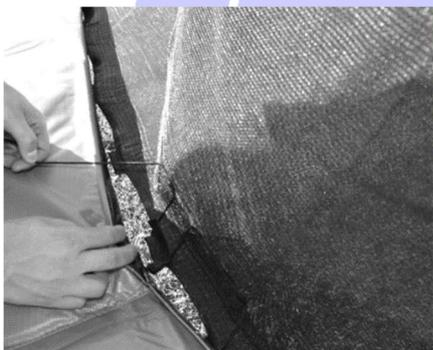
5. Befestigen Sie das untere Ende des Sicherheitsnetzes mit Hilfe der Schnur direkt an den Dreieckringen der Sprungmatte.
